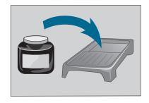
2: Prepare el último rodillo grande nuevo de 15 cm (6") en el mango. Asegúrese de que el rodillo está totalmente impregnado de TopCoat y páselo por la superficie del recipiente para la pintura hasta distribuir la pintura uniformemente. Aplique el producto TopCoat en toda el área entre las tiras de cinta adhesiva.
